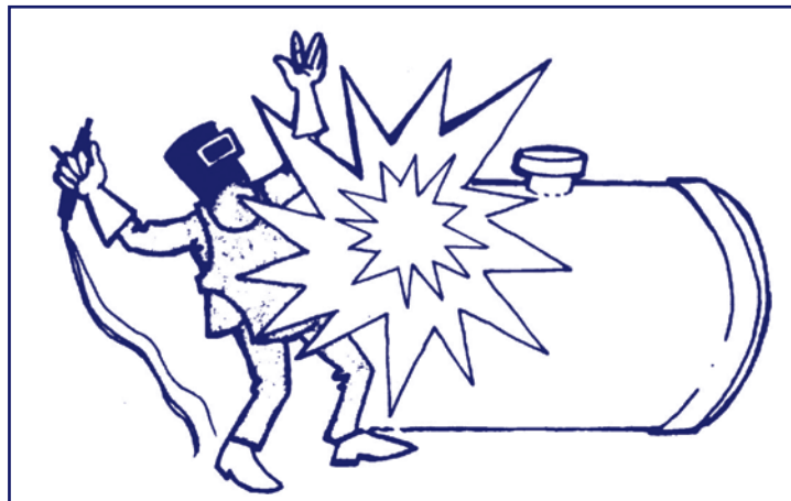
Fig. 1 - Explosion due à un dégazage incomplet
