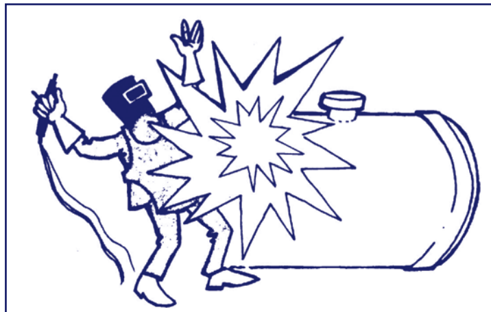
Fig. 1 - Explosion due à un dégazage incomplet
