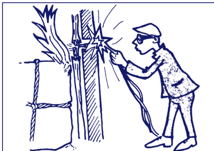
Fig. 2 - Inflammation au contact de conduites invisibles chauffées
